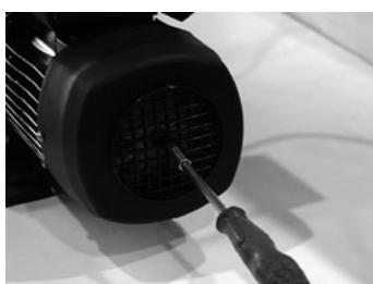
Para evitar bloqueo del sello mecánico, hacer girar el eje a través del ventilador antes de la puesta en marcha o después de una inutilización prolongada!
