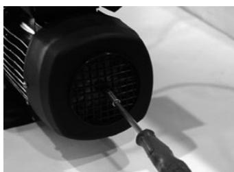
Vor Inbetriebnahme und längerem Stillstand die Achse durch den Lüfter drehen um Gleitringdichtungsperre zu verhindern.
