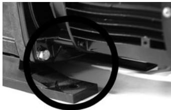
Regelmäßige Kontrolle auf Dichtheit! (Bei undichter Gleitringdichtung schwere Folgeschäden!)
