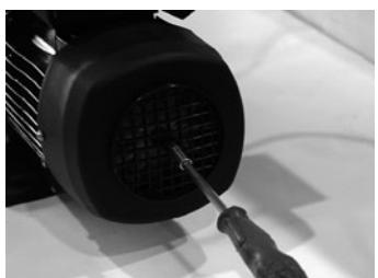
С целью предотвращений блокировки механического запора, перед запуском или после продолжительное неизользование насоса повернуть ось через вентиляторю.
